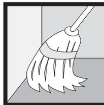
**Рис. 36** - Поверхность основы должна быть чистой. Следует удалить масло, жир, пыль, грязь и отходы, так как они могут отрицательно сказаться на прилипанию клея.
