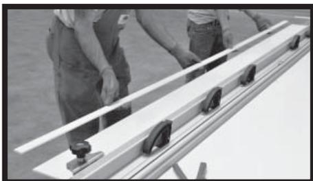
**Рис. 13** - Практичным инструментом для резки является специальная линейка для резки плитки (типа Keracut от **Sigma** или Free-cut от **Raimondi**). В случае с SLIMTECH 3plus и SLIMTECH 5plus, даже используя данное приспособление, после надреза керамической части и отлома плиты, нужно разрезать стекловолокно обычным ножом-резаком (**Рис. 12**).
