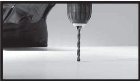
**Рис. 16** - Для ручного сверления использовать вольфрамовые сверла диаметром до 10 мм, установленные на электродрели или шуруповерты на аккумуляторах.
