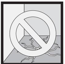
**Рис. 37** - В стяжках на цементной основе наличие трещин от гигрометрической усадки вызывается одним или несколькими из следующих факторов: избыток воды в растворе, слишком мелкая гранулометрия наполнителя, чрезмерное количество цемента. Перед началом укладки необходимо загерметизировать имеющиеся трещины.
