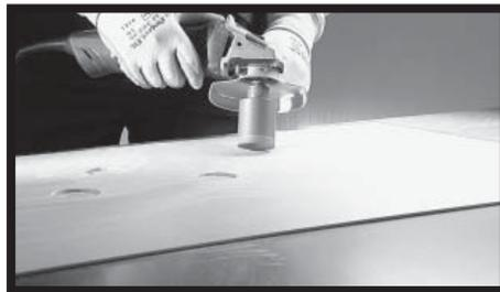
**Рис. 17/18** - В качестве альтернативы можно использовать чашечные фрезы (или цилиндрические), установленные на шлифмашины, электродрели или шуруповерты на аккумуляторах.
