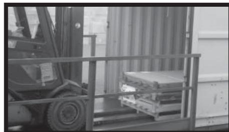
**Рис. 8** - Чтобы взять поддон за короткую сторону (например, при разгрузке из контейнеров), следует обязательно использовать вилы длиной не менее 2,5 м для обеспечения надежного захвата и подъема, а также для гарантии сохранности содержимого.
