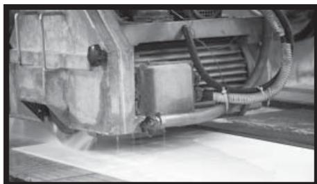
**Рис. 23** - Все разновидности SLIMTECH можно также резать с использованием алмазных дисков. Диски должны быть предназначены для керамогранита и должны находиться в хорошем состоянии. Рекомендуется работать с высокой скоростью вращения (>2000 об/мин) и скоростью движения от 0,5 до 1 м/мин. В зависимости от типа диска и от длины резки может возникнуть необходимость в водяном охлаждении диска.
