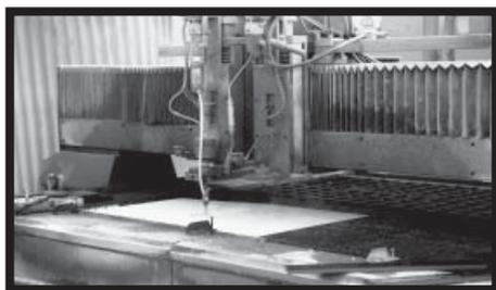
**Рис. 25** - Все разновидности SLIMTECH можно также резать на станках для гидро-резки. Рекомендуем использовать скорость движения от 2 до 3 м/мин.
