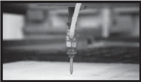
**Рис. 27** - Все разновидности SLIMTECH можно также сверлить с использованием станков для гидрорезки.
